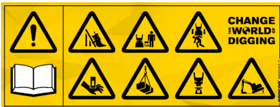
Afbeelding10. Waarschuwingsticker aan rechterzijde van de machinist.
